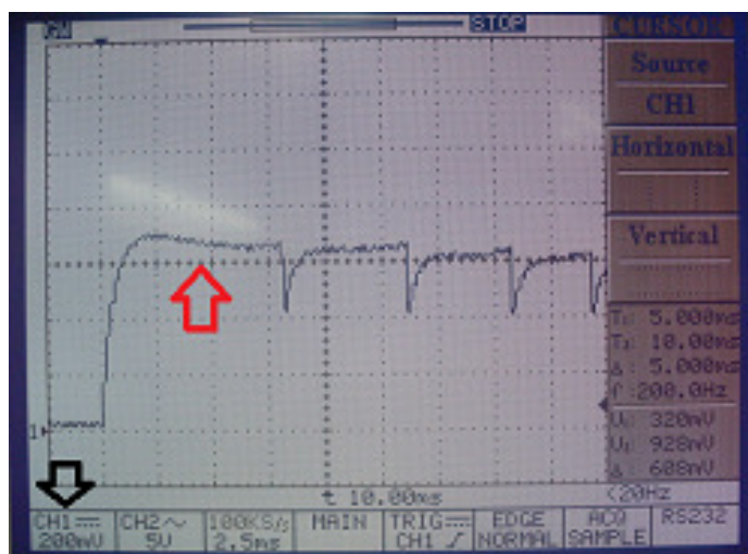
Figura 4.23 Corrente do motor visualizada no osciloscópio.
