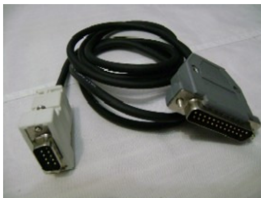
Figura 4.52 Cabo de gravação paralelo
