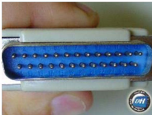
Figura 7: Detalhe do conector de 25 pinos. Veja como cada pino está numerado.
